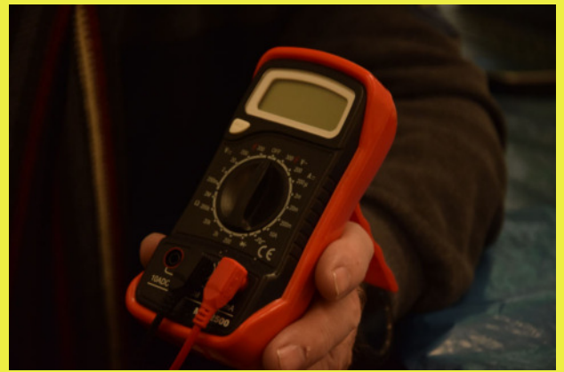
Mit diesem Messgerät kann man zum Beispiel die elektrische Spannung oder die Stromstärke messen.
